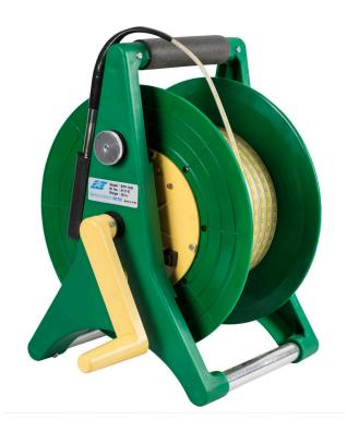
La sonde émet un signal sonore et lumineux lorsque l'eau dans le trou de forage / puits entre en contact avec la pointe. L'électronique résistante à l'humidité et les batteries standard de 9 V PP-3 sont logées dans un concentrateur sur l'enrouleur de câble. Le moyeu peut être facilement retiré pour remplacer la batterie ou vérifier l'électronique sans démonter la bobine de câble entière.
